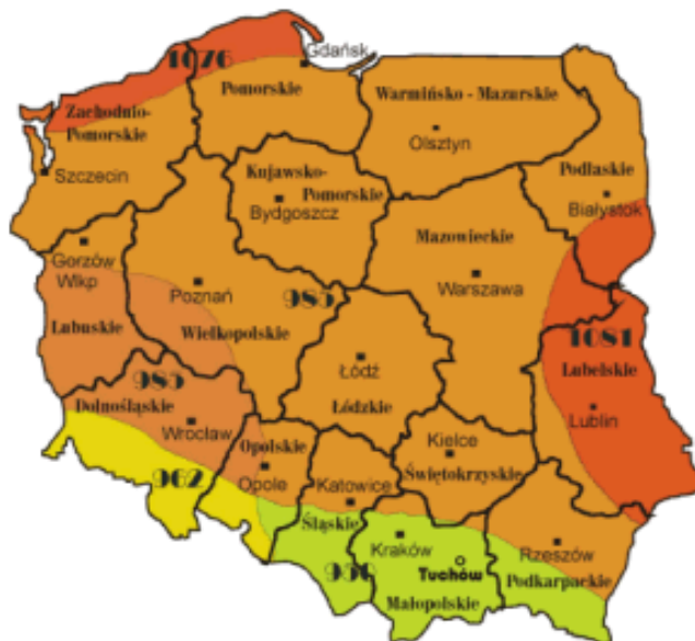
Rysunek 8. Rejonizacja średniorocznych sum promieniowania słonecznego całkowitego padającego na jednostkę powierzchni poziomej w kWh/m 2 /rok. Liczby wskazują całkowite zasoby energii promieniowania słonecznego w ciągu roku dla wskazanych rejonów kraju (źródło: Instytut Meteorologii i Gospodarki Wodnej)
